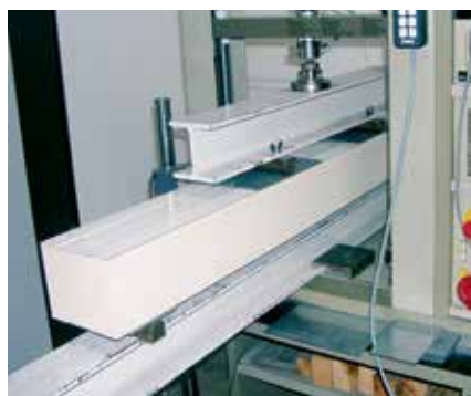
Počítačem podporované zkoušky kvality: zkouška ohybu
