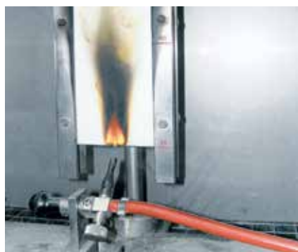
Zkoušky kvality během celého procesu výroby: zkouška hořlavosti
