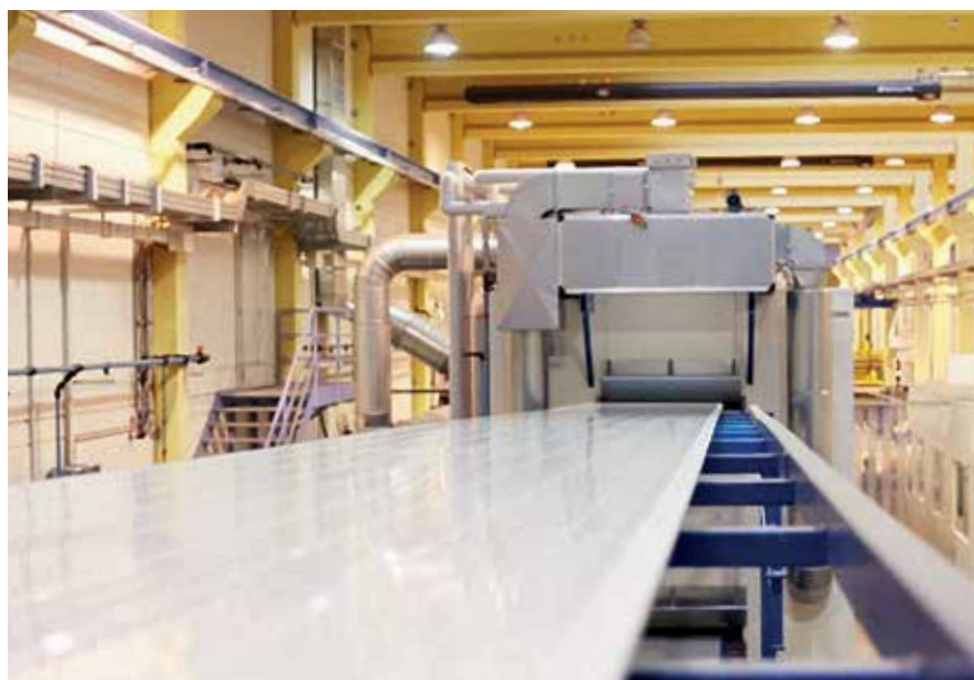
Nepřetržitá výroba sendvičových prvků na nejmodernějších a největších dvoupásových zařízeních světa
